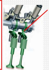
Por otro lado, en esta clase de accionamiento, se ha colocado un balancín con rodamientos. El efecto de reposición permanente de la película lubricante entre la leva y el rodamiento por la rotación del mismo, reduce la posibilidad de corte de película y posibilita el uso de lubricantes de viscosidad HTHS baja del tipo Fuel Economy.
