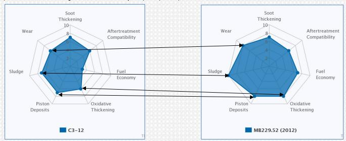
Las imágenes reflejan a grandes rasgos las mayores exigencias que una batería de pruebas de una OEM (Automotriz) con tecnología de punta, somete al lubricante respecto de una especificación ACEA equivalente.
